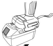
●バッテリーを本製品の溝に合わせ、赤色部分が見えなくなるまで差し込みます。
