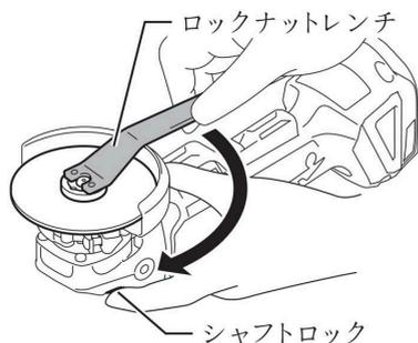
※厚さ3mm以下の砥石の場合、ロックナットのパイロット部(凸部)を上にして、スピンドルにねじ込んでください。
