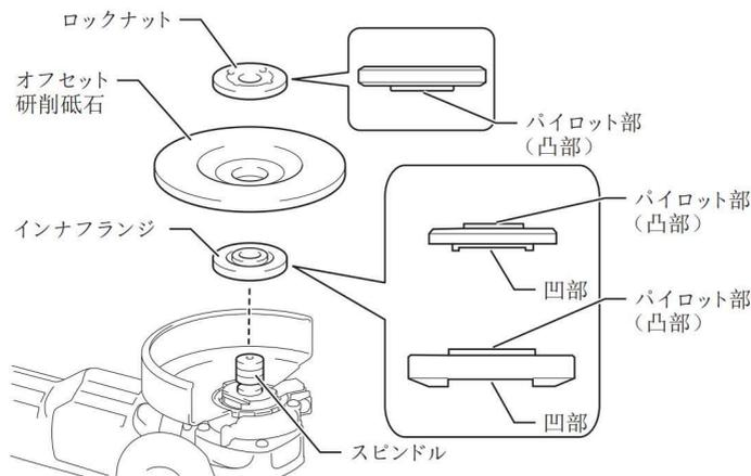
4. シャフトロックを押さえながら、ロックナットをロックナットレンチでしっかり締め付けます。
