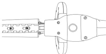
②シャープブレードと本機を繋げている六角穴付きボルト2本を六角レンチ(別売り)で外し、シャープブレードを取り外します。
