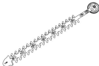
③シャープブレード、クランクを本機の溝に合わせて組みます。
