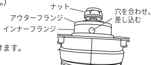
3.アウターフランジを外し、チップソーを取り付けます。
