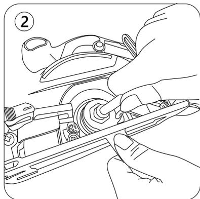
②六角レンチを時計方向に回し、六角ボルトを取り外します。
