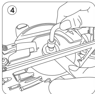
④ アフターフランジ→六角ボルトの順で戻し、六角棒スパナでアフターフランジを押さえながら六角ボルトを反時計方向に回し、しっかり締めてください。
