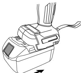
●バッテリーを本製品の溝に合わせ、赤色部分が見えなくなるまで差し込みます。
